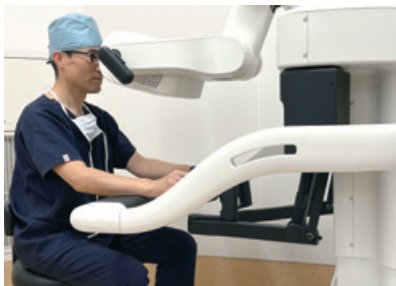
▲hinotori™の操作を訓練する秦教授。従来のロボットに通信機能が加わり、手術中のトラブルに備えメーカーと遠隔で情報が共有できる
